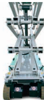
Alustan uusi rakenne mahdollistaa helpon puhdistuksen ja varmistaa komponenttien suojauksen
