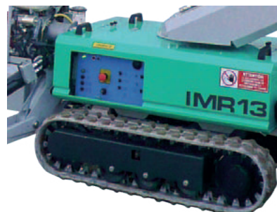
Alhaalla oleva helppokäyttöinen ohjauspaneeli on suojassa koneen rungon ulkokehän sisällä
